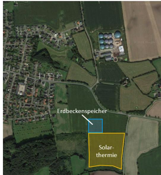
Abb. 50: Größenabschätzung einer solarthermischen Wärmeerzeugungsanlage
