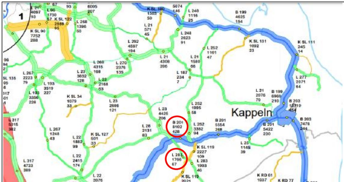
Bild 2: Vorhandene Verkehrsbelastungen B 201 und L 283 im Jahr 2015 gem. Verkehrsmengenkarte SH
